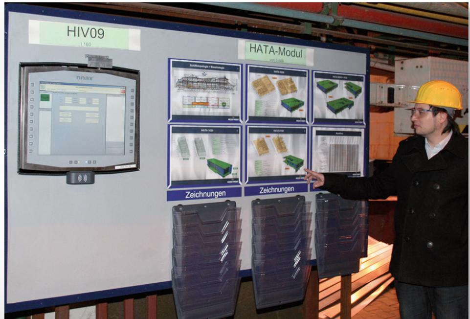
Diese Visualisierungstafel in der Sektionsfertigung zeigt links einen Touchscreen-Monitor und rechts daneben durch Einstecktaschen geschützte Pläne. Darunter sind transparente Sichtboxen montiert, in den bei Bedarf Unterlagen zum Mitnehmen untergebracht werden können. Bild: WEIGANG-Vertriebs-GmbH
